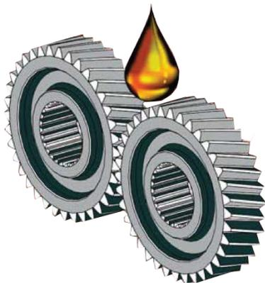
**Nel caso di stoccaggio a magazzino dei riduttori, effettuare il riempimento con apposito lubrificante, per evitare formazioni di ruggine sui componenti interni a seguito di fenomeni di condensa.****Werden getriebe eingelagert, so sind diese zuvor voll/ständig mit dem vorgeschriebenen schmiermittel zu befüllen, um flugrostbildung zu vermeiden.**
